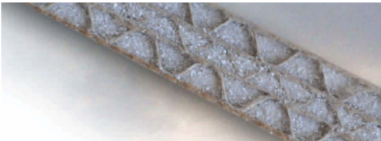
Звукоизоляционная плита PhoneStar в разрезе.
