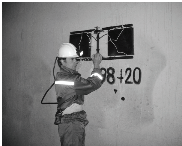
Рис.6а. Рабочий момент зондирования «лба» забоя георадаром «ТР-ГЕО» (вып.2005 г.)
