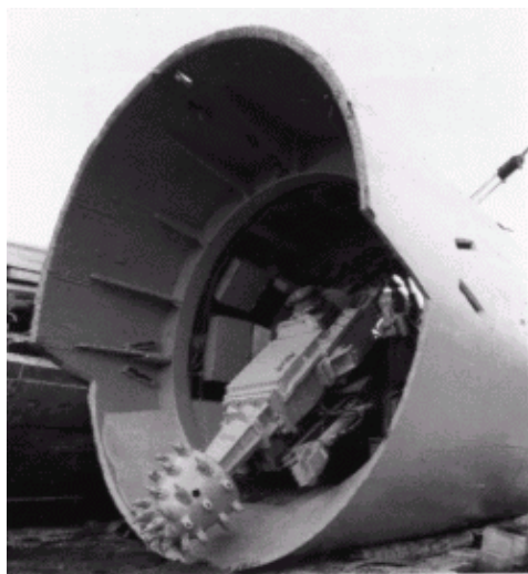
Рис.5. Проходческий щит, оборудованный шарошкой
